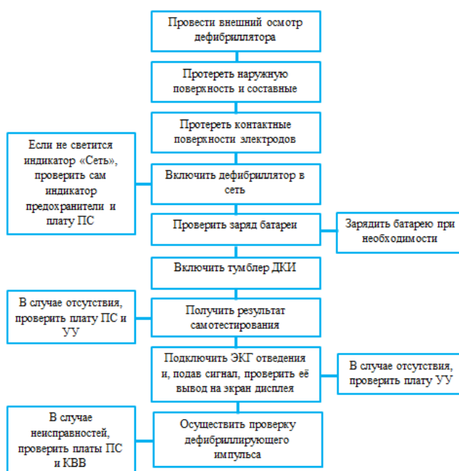
Рис. 1. Блок-схема поиска неисправностей ДКИ-Н-08
