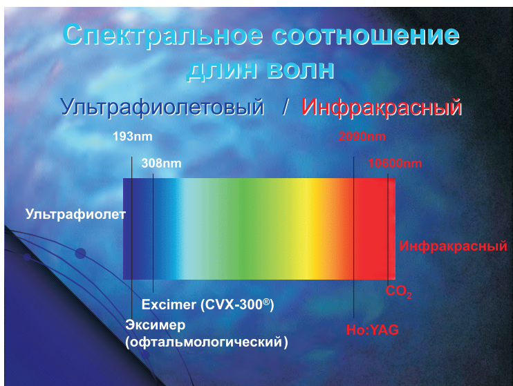
Рис. V.1. Спектральные характеристики лазерного излучения генерируемого ксенон-хлоридной эксимерной лазерной установкой Spectranetics CVX-300
