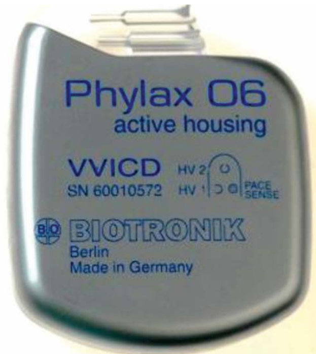
Рис. 10. Двухкамерный кардиовертер-дефибриллятор «Phylax-06», Biotronik, Germany. Музей НМИЦ ССХ им. А.Н. Бакулева Минздрава России, 2022 г.
