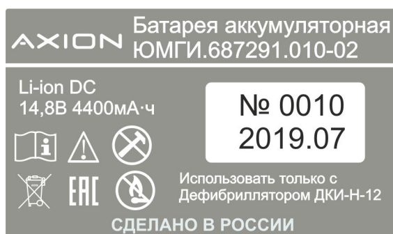
Рисунок 9 – Этикетка на аккумуляторной батарее
