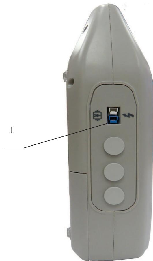
1 - разъем для подключения многофункциональных электродов
