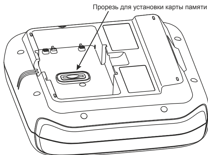
Рисунок 15 — Вид дефибриллятора с тыльной стороны со снятой батареей питания
