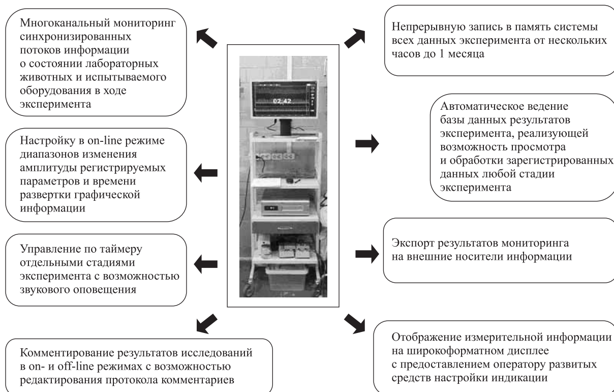
Рис. 2. Функциональные возможности информационно-измерительного комплекса BioMonex®
