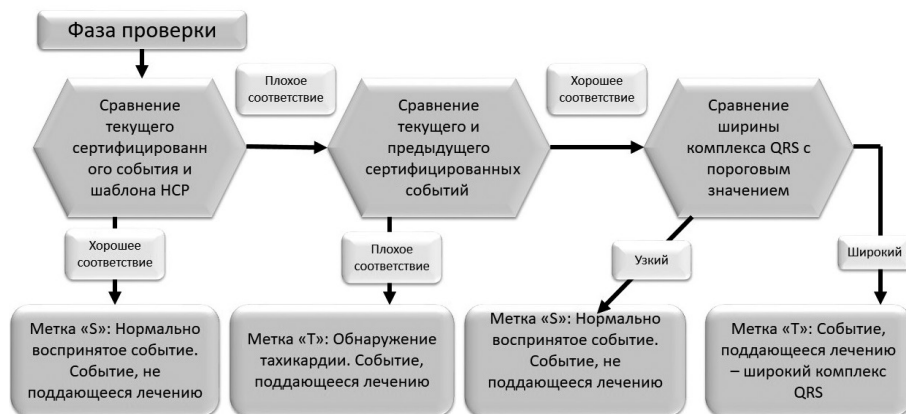
Рис. 6. Схема принятия решения о нанесении шоковой терапии, иллюстрирующая внутреннюю логику аппарата. Адаптировано из [15].
