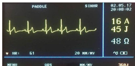
Рисунок 13. Відображення на екрані РЕЖИМУ з КАРДІОСИНХРОНІЗАЦІЄЮ при електроживленні дефібрилятора від мережі і роботі з електродами «Рука – Рука». Трансторакальний опір пацієнта 48 Ом.
