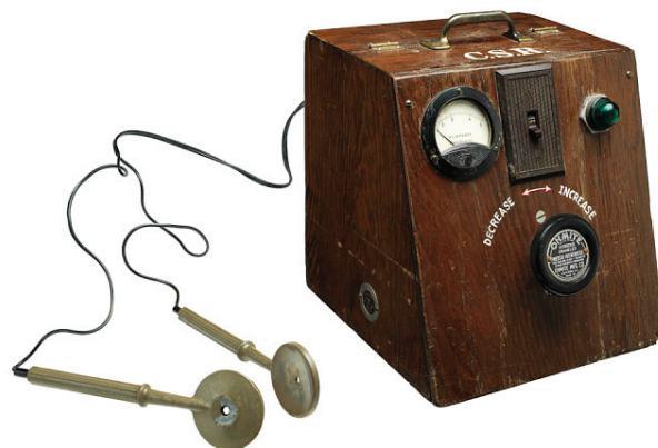
Рис. 2. Дефибриллятор К. Бека конструкции Дж. Рэнда (1947 г.). Дар Клода Бека отделу медицины и науки Национального музея американской истории Смитсоновского института (США)
