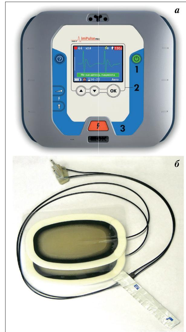
Рис. 4. а – автоматический наружный дефибриллятор imPulse PRO АНД-П01; б – одноразовые kleящиеся электроды дефибриллятора, обеспечивающие уменьшение повреждения кожи, расположенной под электродами.
