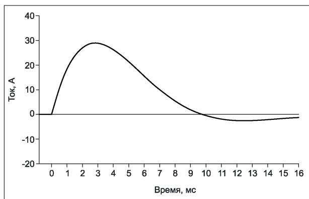
Рис. 2. Монополярный импульс Гурвича-Юньева при сопротивлении нагрузки 100 Ом.
