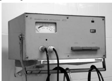
Рис. 1. Дефибриллятор ДИ-03
