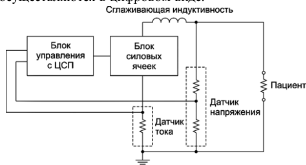
Рис. 2. Функциональная схема модуля формирования импульса Гурвича-Венина с использованием цифрового сигнального процессора (ЦСП)
