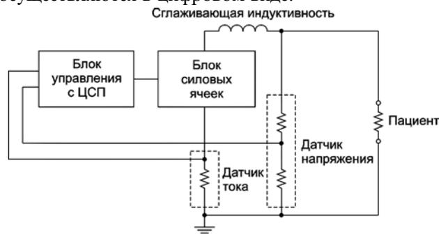
Рис. 2. Функциональная схема модуля формирования импульса Гурвича-Венина с использованием цифрового сигнального процессора (ЦСП)
