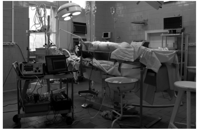
Рис. 4. Общий вид автоматизированного комплекса для экспериментальных исследований на животных
