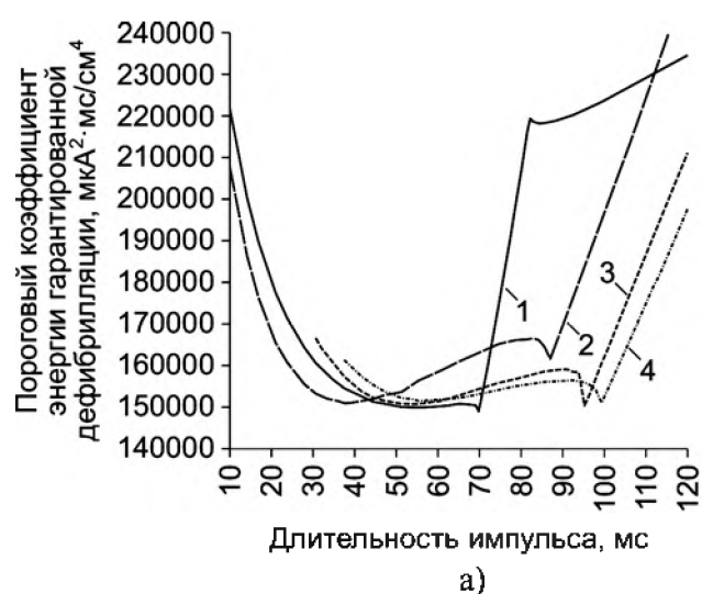
Рис. 4. Дефибрилляционный полусинусоидальный импульс и трапецеидальные дефибрилляционные импульсы с пологими фронтами и срезами с длительностью фронта t_f = 15 мс и различными длительностями среза (1 — полусинусоидальный импульс; 2 — t_c = 0,01 мс; 3 — t_c = 16 мс; 4 — t_c = 20 мс): а) диаграммы зависимости пороговой энергии гарантированной дефибрилляции от длительности импульса; б) формы энергетически оптимальных импульсов
