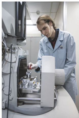
Загрузка образца в рабочую камеру электронно-ионного микроскопа Hellios NanoLab 650
