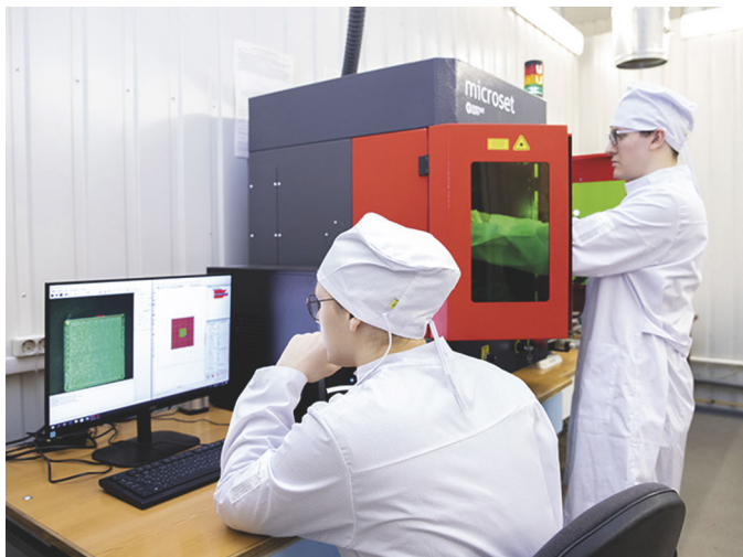
Выполнение технологической операции с помощью системы позиционирования прецизионной лазерной микрообработки материалов (НИЛ ТКПМ)
