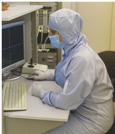
Контроль фотошаблонов на соответствие проектным данным
