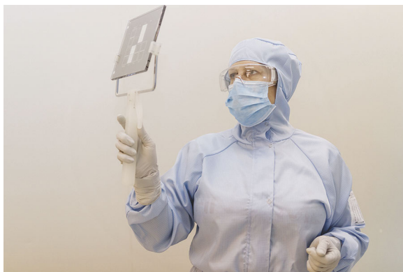
Изготовление стандартных бинарных фотошаблонов для производства ИС уровня 180 нм
