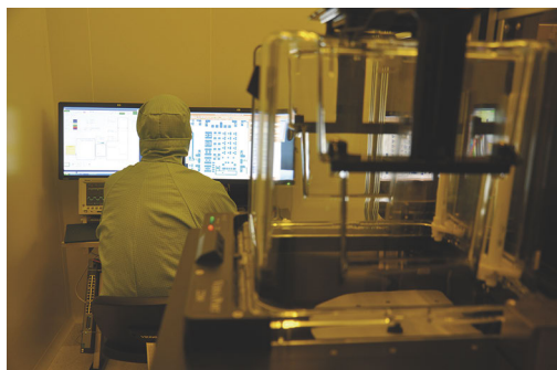
Формирование изображения ИС на фотошаблоне электронно-лучевым и лазерным методами
