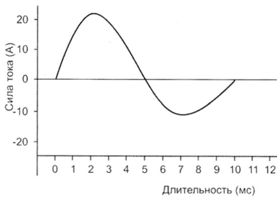
Рис. 1. Биполярный асимметричный квазисинусоидальный импульс (импульс Гурвича – Венина)
