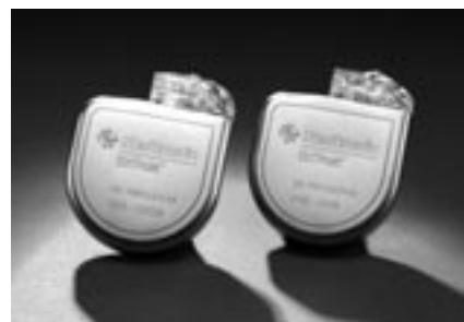
Рис. 2. Современные ИКД – двухкамерный и однокамерный (36 см 3 , масса 75 г, закругленный корпус, энергия шока – 35 Дж, программируемый активный корпус).
